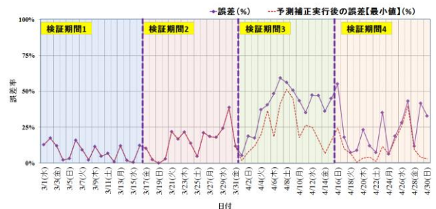
図-4-2 プラント冷水供給熱量誤差率推移グラフ
